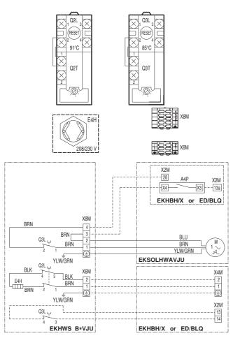
Localiser le bornier X8M dans le coffret électrique du ballon d'eau chaude domestique et effectuer les connexions requises:
