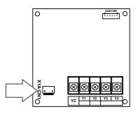
5 Monter les cales en plastique du sac d'accessoires sur la plaque arrière du boîtier de commutation EKHB interne. 6 Monter la carte de circuits imprimés EKRP1HB sur les cales en plastique.
